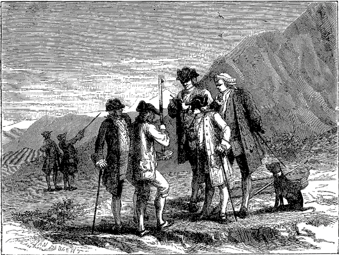
Périer mesurant la hauteur du tube de Torricelli sur le haut du Puy-de-Dôme
