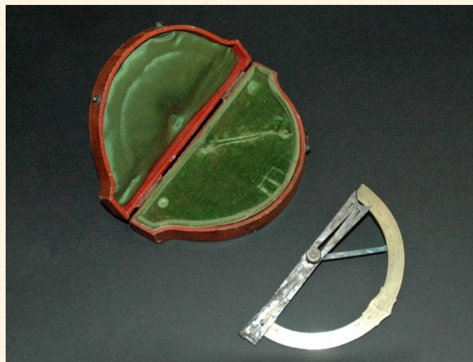
Goniomètre d'application de Carangeot, acquisition antérieure à 1888, collection de Physique, Université Lille 1
